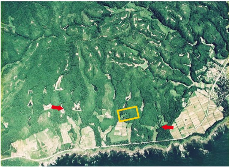
四角は志賀原発原子炉建屋の立地場所。矢印で示す方向に直線が引け、活断層による地形変動が見える
